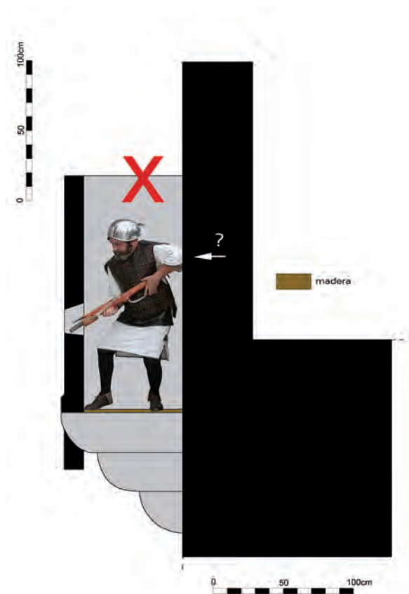
Fig. 52: La "aspillera" de la ladronera del Lienzo 1 hubo de funcionar como mirilla ya que queda prácticamente inutilizada como aspillera propiamente dicha debido a su diseño, además de por la excesiva estrechez de la caja de la misma ladronera, que imposibilita el tiro con arco o ballesta.
